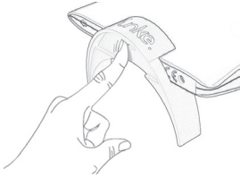
Bevestig het voetje onderaan de antenne
